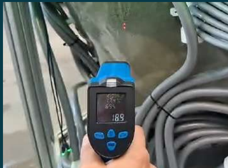
Température à l'extérieur de la cuve de 18,9°C Isolation optimale; 17°C d'écart !
